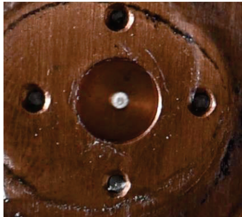
FIG. 1 成膜した固体水素薄膜を、真空中に保持している様子。温度が十分に低下したため、1時間以上真空で保持できた。直径1 mmのオリフィス（ピンホール）部分のみに固体水素が成膜された。また、薄膜の厚さは基板厚さ（写真は500 \mu\text{m} ）以下となる。基板は厚さを変えられるように交換可能とした。
