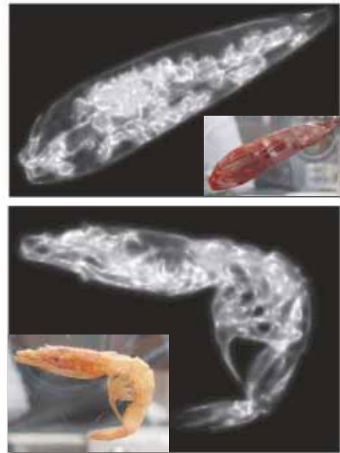
図 5 THz-TDS システムを用いて観測した唐辛子・えびの透過イメージ。
