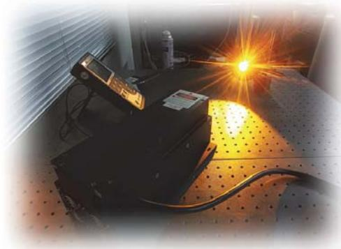
図 1 開発した  $589\text{nm}$  レーザー発振の様子。
