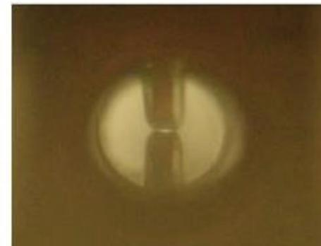
FIG. (上) 膜厚 10~50 μmの固体水素にレーザー\*を照射したときに加速される陽子のエネルギースペクトル (\*LFEXフルパワーを想定)。(下) 固体水素薄膜生成装置の概要と、真空中に生成した水素薄膜。
