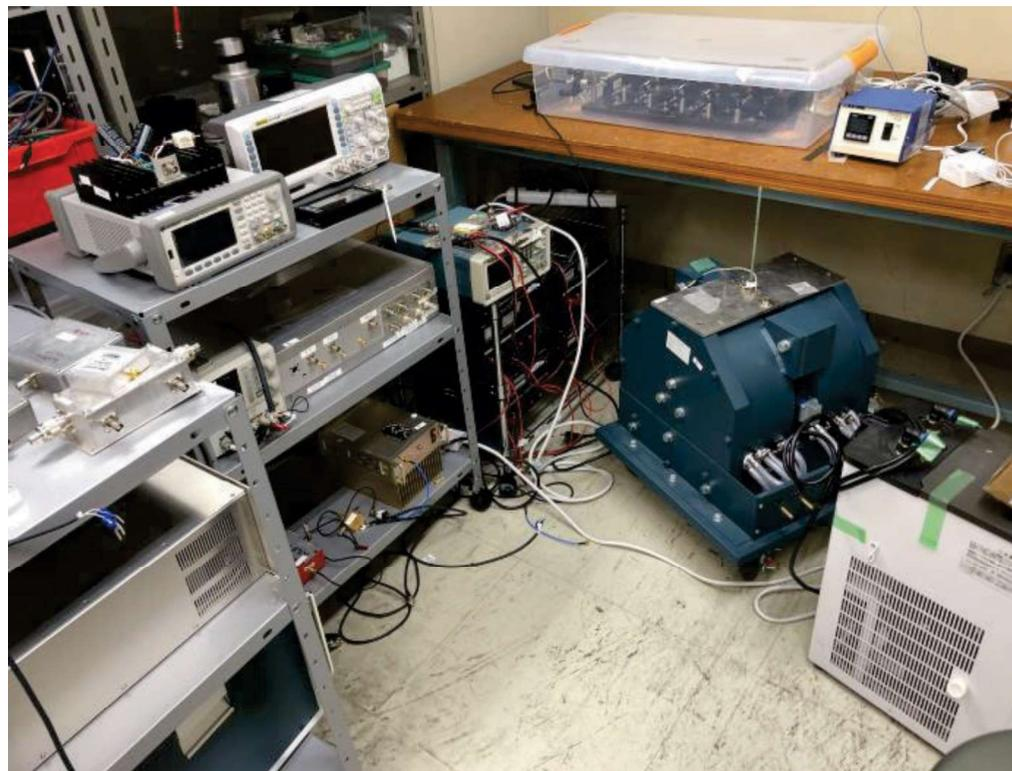
FIG1. レーザー研の実験室に構築した動的核偏極生成・観測装置
