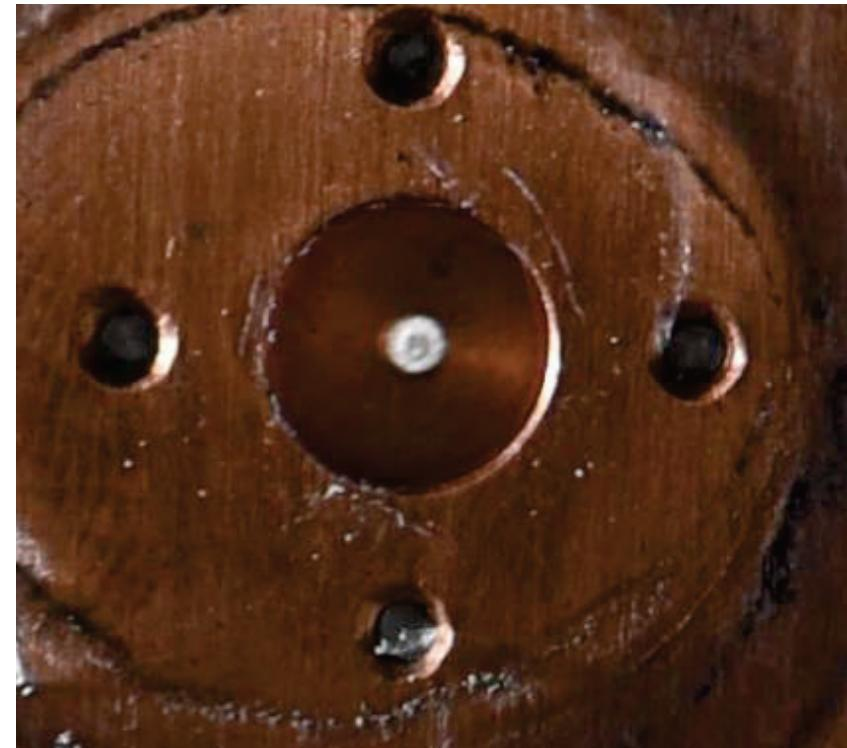
FIG. 1 成膜した固体水素薄膜を、真空中に保持している様子。温度が十分に低下したため、1時間以上真空で保持できた。直径1 mmのオリフィス（ピンホール）部分のみに固体水素が成膜された。また、薄膜の厚さは基板厚さ（写真は500μm）以下となる。基板は厚さを変えられるように交換可能とした。
