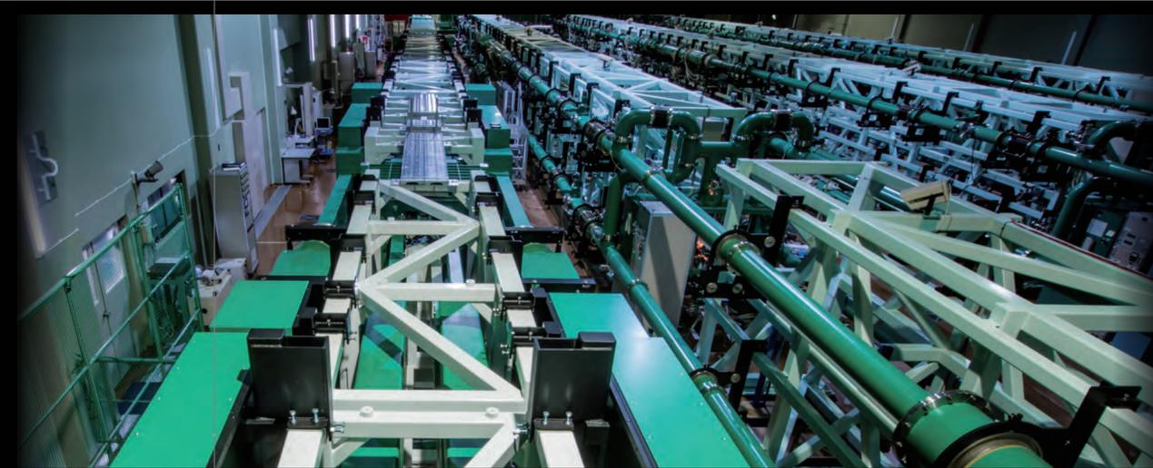
◀ 世界最高出力の超強度レーザー装置 LFEX
