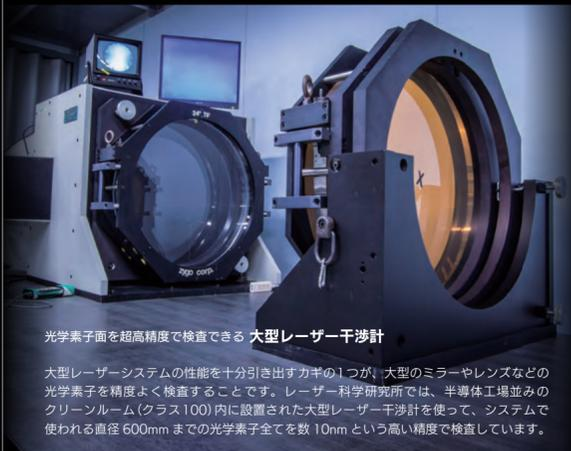
光学素子面を超高精度で検査できる 大型レーザー干渉計
