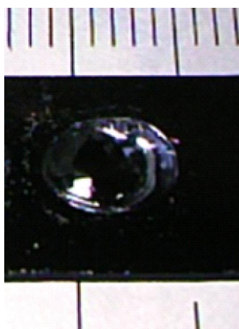
図 2 ArF エキシマレーザー照射によりシリコンウェハ表面に形成されたシリカレンズ
