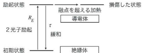
(図 2) 光学材料の原子過程モデル
