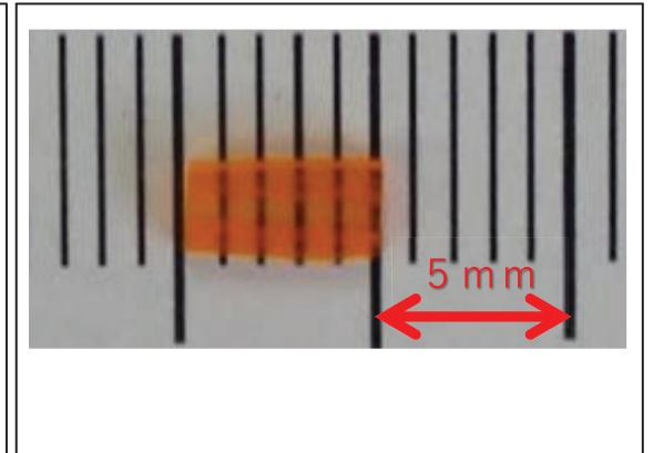
FIG. 開発中の赤色発光シンチレータの写真
