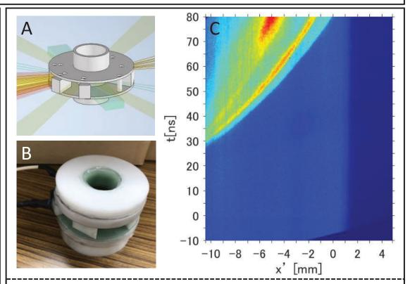
FIG. A) The holder of magnetic coil and a number of light paths. B) Photo of the magnetic coil system after electric insulating treatment. C) Measured self-emission intensity obtained from the SOP measurement. 高分解能X線シャドウグラフィ法を用いた強磁場による 界面流体不安定性の抑制条件の実験的検証 <sup>佐野孝好, 郭署旺, 朱保君, 松尾一輝, 嶽村真緒, 敦近原, 王雨波, 藤岡慎介 大阪大学レーザー科学研究所 Institute of Laser Engineering, Osaka University</sup>
