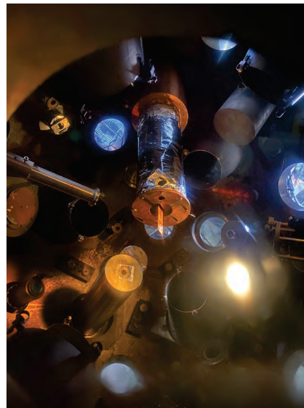
FIG. 1 装置をターゲットチャンバーへ取り付け固体水素形成後、薄膜部をターゲットセンターへ移動しショット直前の様子。
