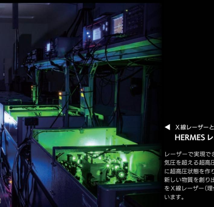
◀ X線レーザーと同時に照射できるHERMES レーザー装置
