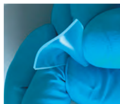
Fig. 6 透明、フレキシブル材料であるPDMSシート。生体適合性が高い。
